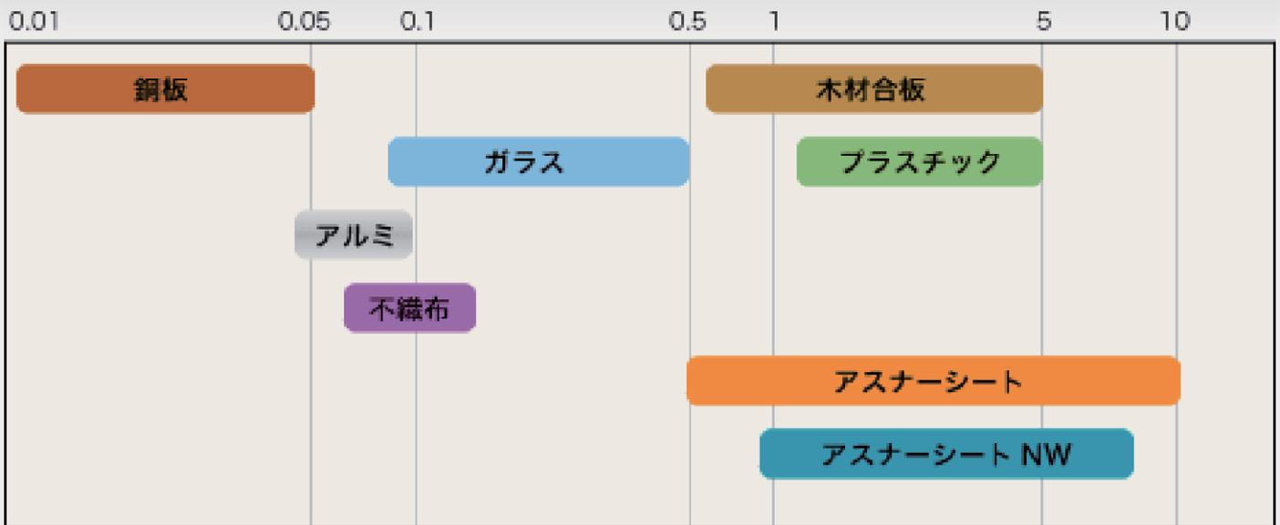
※アルミ板の間にダンパーとして、ゴム、不織布等をサンドイッチした積層版の損失係数 n を測定した結果です。
